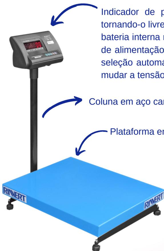
Indicador de pesagem modelo WT1000 LED, feito em plástico ABS tornando-o livre de ferrugem. Display de pesagem em LED, equipado com bateria interna recarregável 6v/4,5Ah, (autonomia de até 15 horas). Fonte de alimentação de energia AC 110/220 50/60HZ, chaveada interna, com seleção automática, sem necessidade de abertura do equipamento para mudar a tensão de operação.
