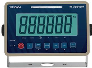
Cápsula em ABS, Grau de proteção IP68, Display LCD de 6 dígitos, com backlight. Interfaces de comunicação- saída serial RS232, Bluetooth ou RS485.
