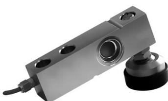
Possui 4 células de carga modelo BTBI, limite de carga de segurança 150% da capacidade nominal. Sobrecarga de ruptura 250% da capacidade nominal.
